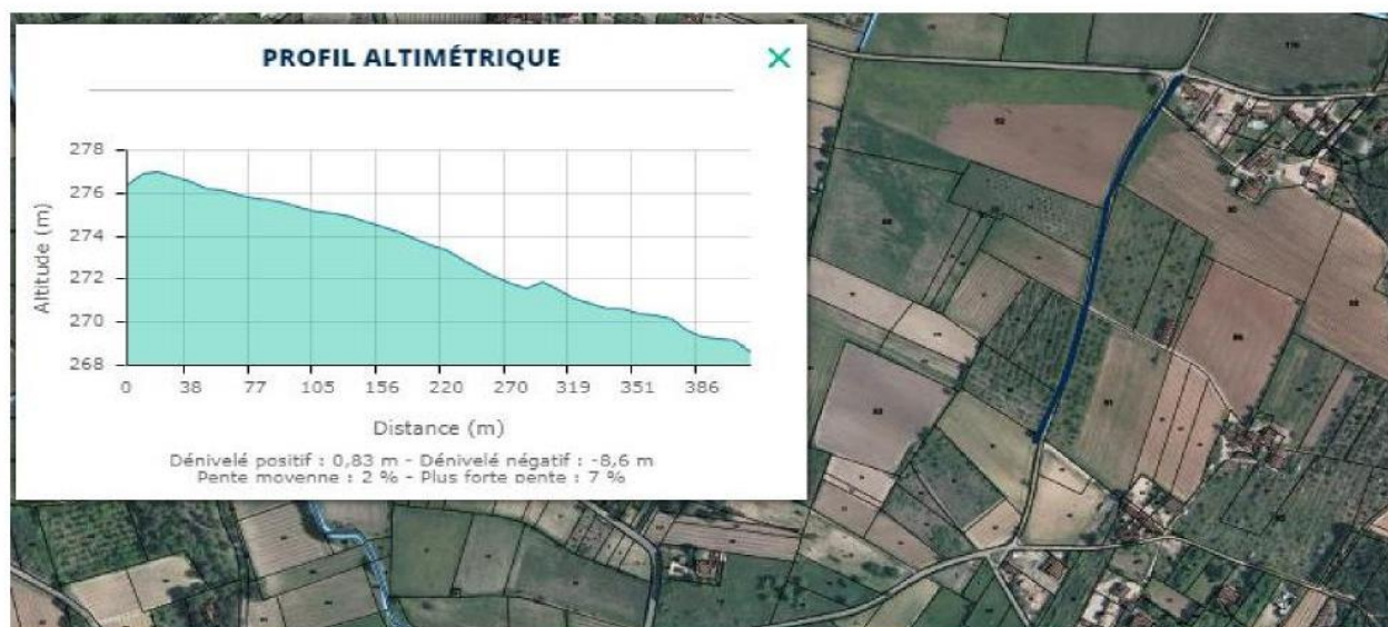
Simulation d'un tracé de raccordement au réseau d'assainissement collectif et profil altimétrique
