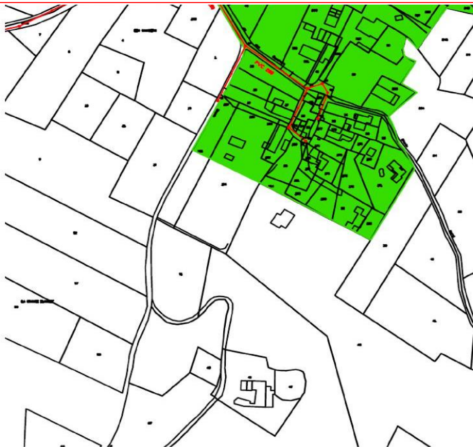
Extrait plan de réseau (en rouge) et zonage d'assainissement (collectif en vert)
